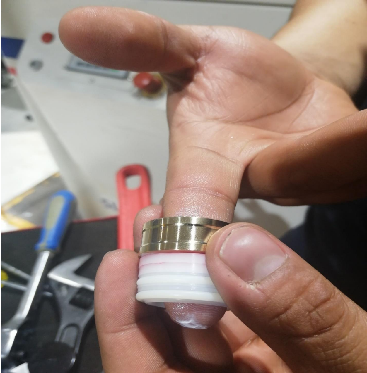
Ilustración 5 sello de refacción nuevo
