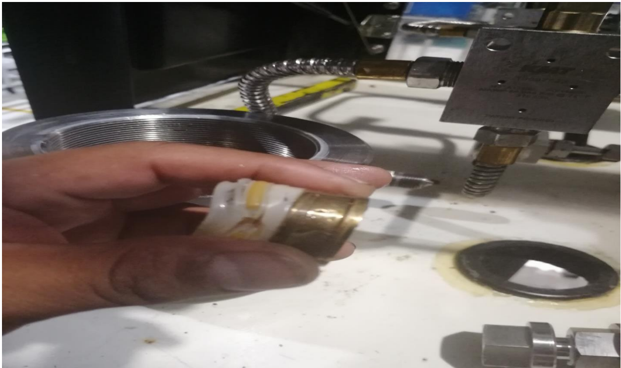
Ilustración 4 sello de agua dañado
