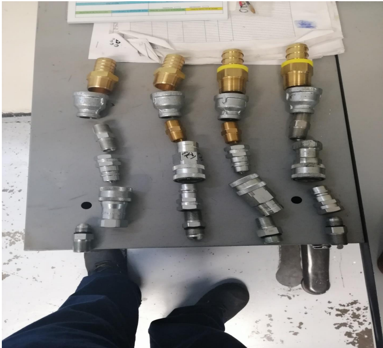
Ilustración 7 Elementos de conexión a intercambiador
