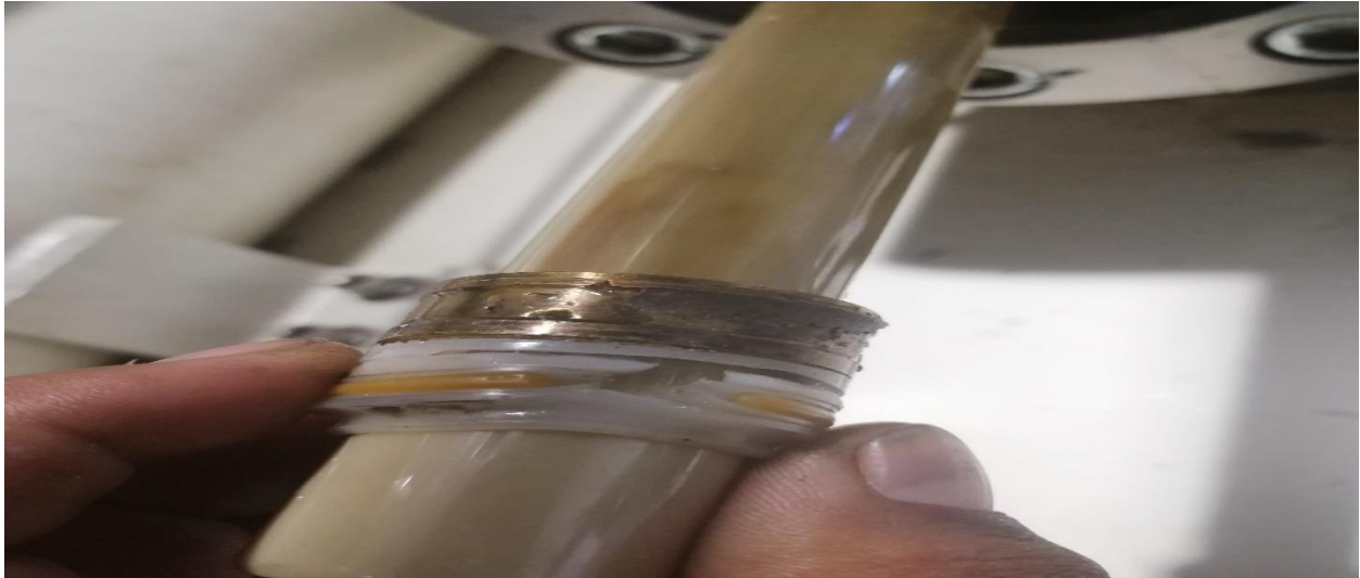
Ilustración 3 Sello de agua dañado
